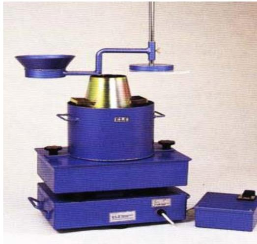
شكل رقم (5) جهاز Vebe
