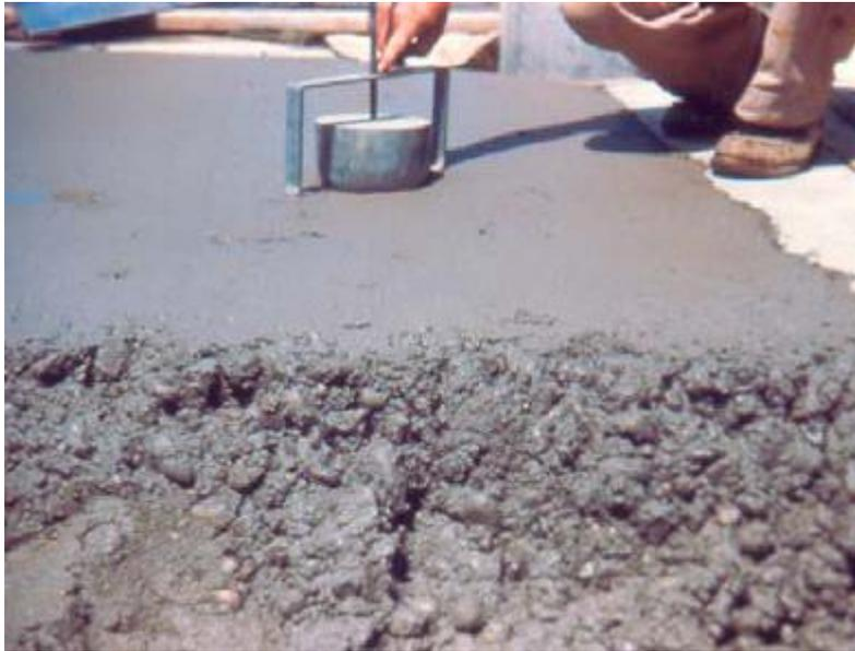
شكل رقم (7-B) جهاز كرة كيللي للاختراق لفحص قوام الخرسانة
