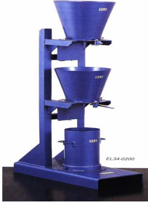
شكل (B-3) جهاز عامل الرص
