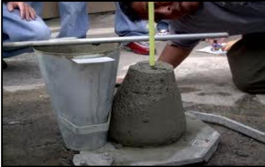
شكل رقم (1-B) يبين كيفية قياس الهطول
