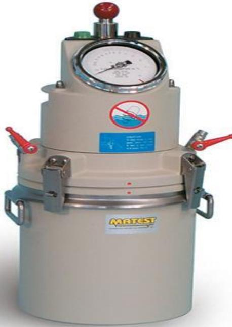
شكل (1-B): جهاز من نوع اخر لقياس محتوى الهواء بطريقة الضغط
