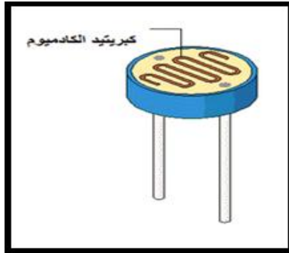
الشكل(2) يوضح تركيب المقاومة الضوئية
