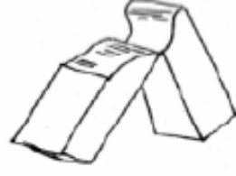
شكل الكسر لمعدن مطيل
