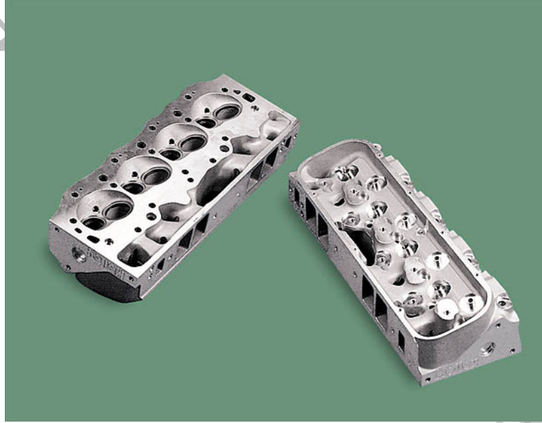
شكل ٢ - ٢٩: رأس الأسطوانات تستخدم لحبك قمة المحرك ويثبت عليها الصمامات والحواقن أو شمعات الإشعال
