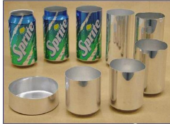
مراحل السحب العميق المتعددة لإنتاج أوعية الصودا
